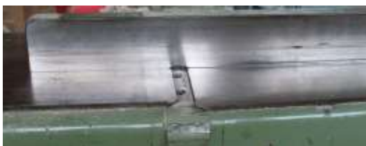
Abb. 3. Messerwelle und Hobelmesser der Holzhobelmaschine
