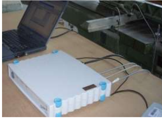
Abb. 4. Messsystem zum Messen der Vibrationen
