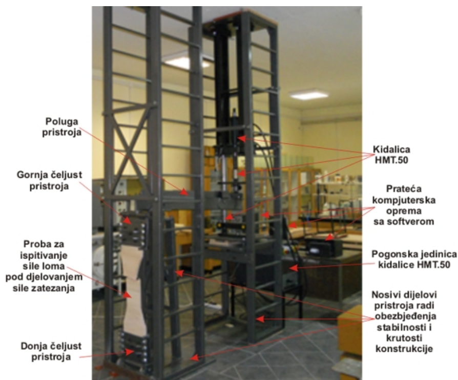
Slika 1. Kidalica HMT.50.EM sa pristrojem za ispitivanje zatezne čvrstoće šperploče
