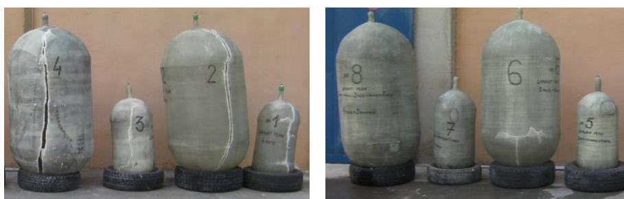
Slika 3. a) Izgled popuštanja posuda izrađenih od ojačanja u obliku mate (lijevo) b) Izgled popuštanja posuda izrađenih od ojačanja u obliku mate i rowinga (desno)
