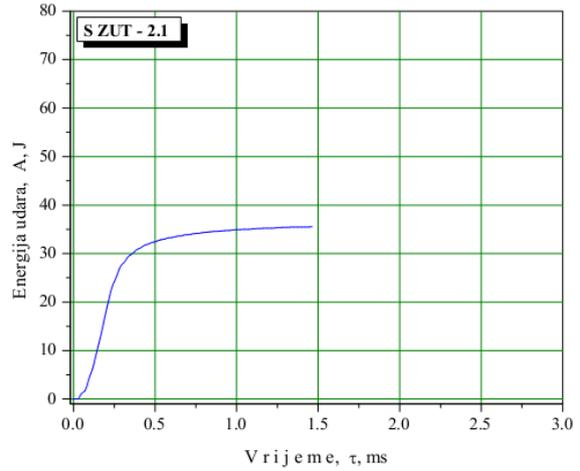
Slika 6 Dijagrami dobijeni udarnim ispitivanjem epruvete SZUT – 2.1 [2]
