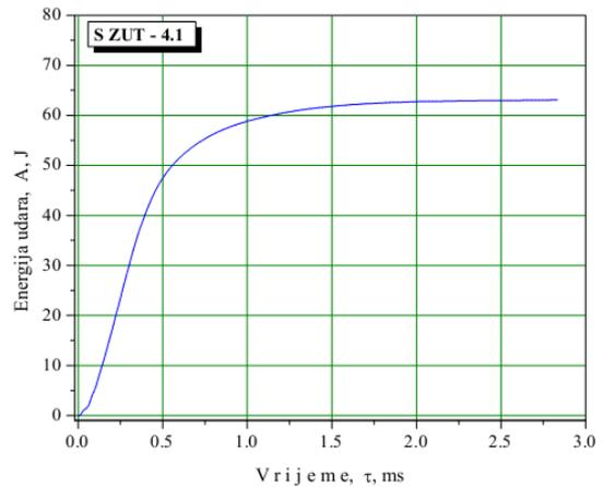
Slika 8 Dijagrami dobijeni udarnim ispitivanjem epruvete SZUT – 4.1 [2]
