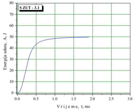
Slika 7 Dijagrami dobijeni udarnim ispitivanjem epruvete SZUT – 3.1 [2]
