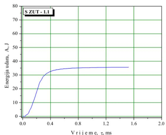
Slika 5 Dijagrami dobijeni udarnim ispitivanjem epruvete S ZUT - 1.1 [2]
