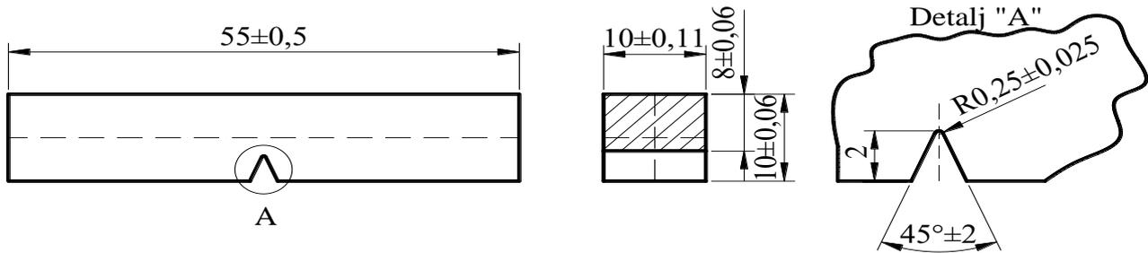
Slika 3. Epruveta za određivanje energije udara [12]
