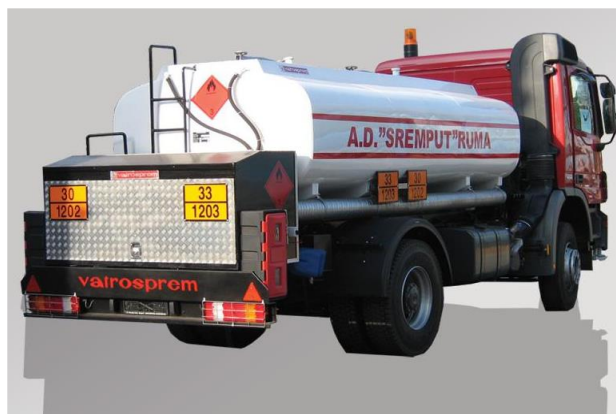
Slika 3.3. Propisno obilježeno vozilo za cestovni transport naftnih derivata
