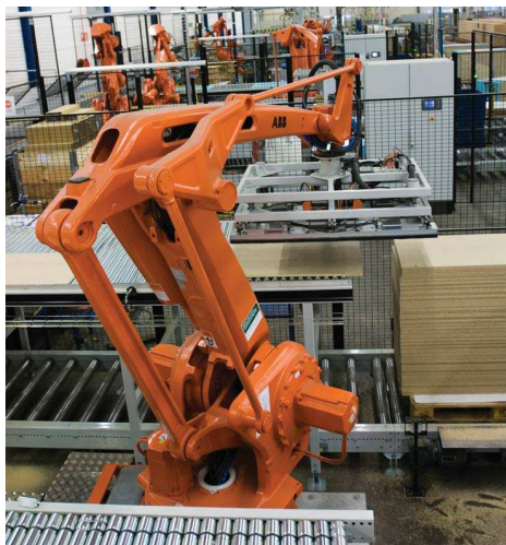
Slika 7. Primjena robota u proizvodnji pločastog namještaja
