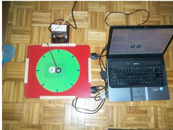
Slika 4: Izgled gotovog sistema za upravljanje istosmjernim motorom upotrebom mikrokontrolera PIC16F877A i MATLAB@SIMULINK Real-Time toolbox-a
